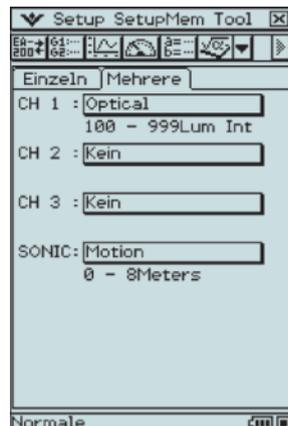
Im Setup-Menü unter *Probe* wird der Modus *Normale*, das Messintervall *0,05 Sekunden* und die Anzahl der Messungen *600* eingegeben.
