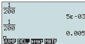
In der Standardeinstellung „Norm 1“ werden nur Zahlen im Intervall  $[10^{-2}; 10^{10}]$  als Dezimalzahlen dargestellt (vgl. Abb. oben). Dieses Intervall wird mit der Einstellung „Norm 2“ auf  $[10^{-9}; 10^{10}]$  erweitert (vgl. Abb. unten). Die Darstellungsnorm wird im SETUP unter „Display“ ausgewählt.
