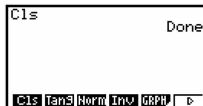
Anschließend drücken Sie die Tasten [OPTN] [F6] (▷) [F6] (▷) [F2] (PICT) [F2] (Rcl) und zum Anzeigen des Graphikbildes, welches sich auf dem 1. Speicherplatz befindet, die Tasten [ 1 ] [EXE].
