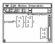
$$\vec{a} \times \vec{b} = \begin{pmatrix} -1\\7\\1 \end{pmatrix} \times \begin{pmatrix} -3\\2\\2 \end{pmatrix} = \begin{pmatrix} 12\\-1\\19 \end{pmatrix}$$
