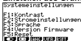
Das linke Sichtfenster erhält man über das Menü SYSTEM. Vor Klausuren ist eine Rückstellung empfehlenswert. Nachdem die Rückstellung (F5) gewählt wurde, kann über F6 und F1 der Haupt- und Massenspeicher gelöscht werden.
