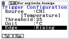
Die Messstatus-LED (rechts) leuchtet blau. Nach der Konfiguration erscheint die Aufforderung "Start sampling?", die Sie mit [EXE] bestätigen müssen. Die LED blinkt nun blau, aber sonst passiert zunächst nichts.
