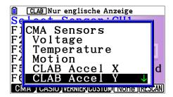
Stellen Sie mit Methode 2 die Rate auf 10 Werte pro Sekunde und die Messdauer auf 20 Sekunden ein. Wählen Sie als Trigger den Start-Button des C-LAB
