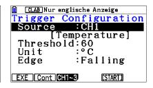
Die aktuelle Wassertemperatur beträgt 67,6°C. Da die Messung über einen Trigger gestartet werden soll, muss die Triggerschwelle einige Grad unter dieser Temperatur liegen. Hier sind es 60°C (vgl. Abschnitt 2.4).
