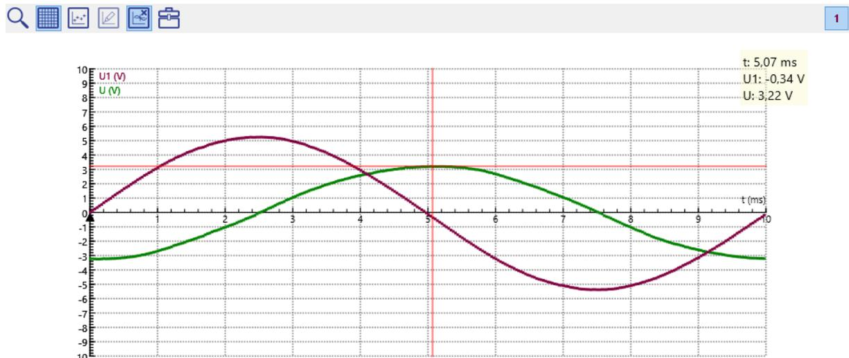
Es wird hier der Maximalwert für die Spannung am ohmschen Widerstand bestimmt. Der Maximalwert der Spannung am Kondensator wurde bereits bei Aufgabe 1.1. ermittelt.
