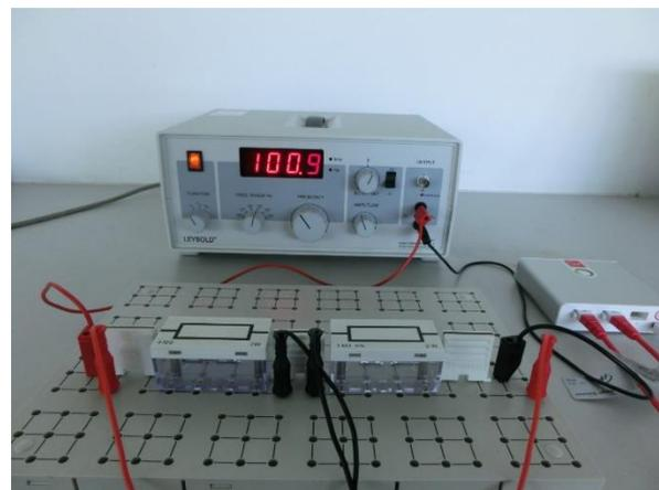
In der Schaltung im linken Bild werden die am rechten Widerstand und an beiden Widerständen anliegenden Spannungen gemessen. Durch Verlegen beider Massen auf die
